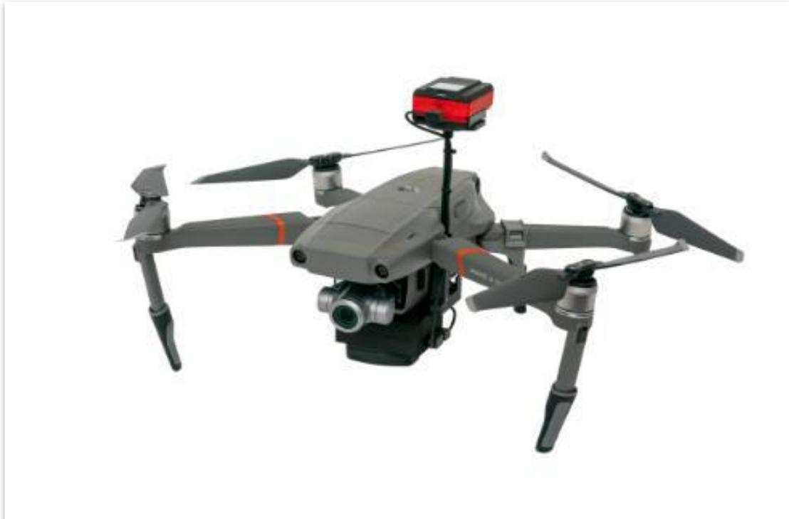
Los sensores aéreos (fotogrametría, termografía aérea infrarroja TIR, fotografía aérea infrarroja IR y multispectral MS) están colocados en microdrones, con autonomía superior a 20 minutos continuos de vuelo, y se despliegan a una altura predeterminada y con una metodología concreta y predeterminada. En esta prospección, se ha utilizado DJI Mavic 3 Thermal PRO. En la fotografía adjunta, Mavic dotado de cámara multispectral Parrot Sequoia.
