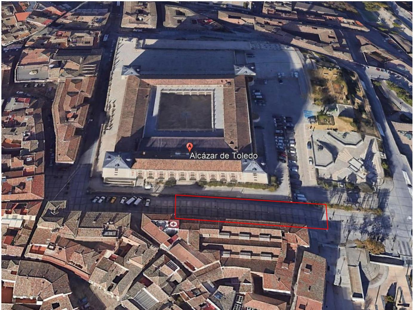
Línea roja perimetral área analizada mediante sensores aéreos, georadar, magnetómetro y perfilómetro. Terreno cuasi homogéneo, apto para prospección geofísica normalizada, se ha realizado con metodología correcta, interno y en todo el perímetro, mediante georadar, magnetómetro y perfilómetro. El terreno ha sido prospectado mediante sensores aéreos infrarrojos/multiespectrales y manualmente con carro radar, magnetómetro y perfilómetro multifrecuencia.
