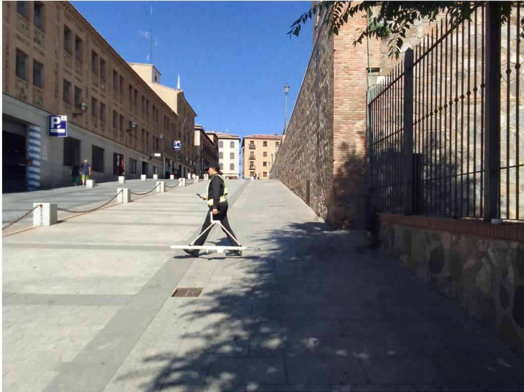
Uso de perfilómetro electromagnético, multifrecuencia durante la toma de datos, mediante un barrido a una altura aproximada de 0,20 m sobre la superficie. Este equipo permite realizar un posicionamiento exacto de las anomalías electromagnéticas asociables a presencia de posibles estructuras en subsuelo, ya que es muy sensible y está dotado de diferencial GPS y de tres frecuencias, y permite el desplazamiento por zonas irregulares o con obstáculos superficiales.
